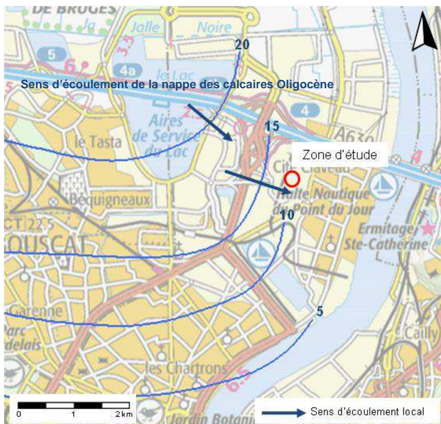
Figure 3 : Isopièzes de la nappe semi-profonde des calcaires datée de l'Oligocène (source : SIGES Aquitaine)
